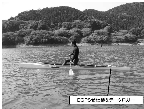
図1. 水上での艇へのDGPS搭載の様子
